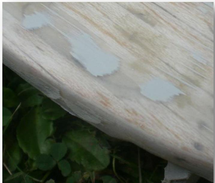
Schichten und anschließendes Schleifen (240er bis 400er Korn, nass) füllt diese nach und nach. Geschliffen werden muss deshalb, weil die Umgebung um die Mulde sich ebenfalls „erhöht“.
