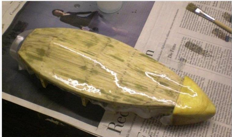
einfach mit einem Pinsel Harz aufgetragen und angetupft. Nach der Trocknung waren an manchen Stellen der Oberfläche noch Gewebemuster zu erkennen, deshalb nochmal ein wenig Harz oder Gelcoat auftragen. Die überschüssigen Gewebereste am Rand mit einem Skalpell sauber abschneiden.
