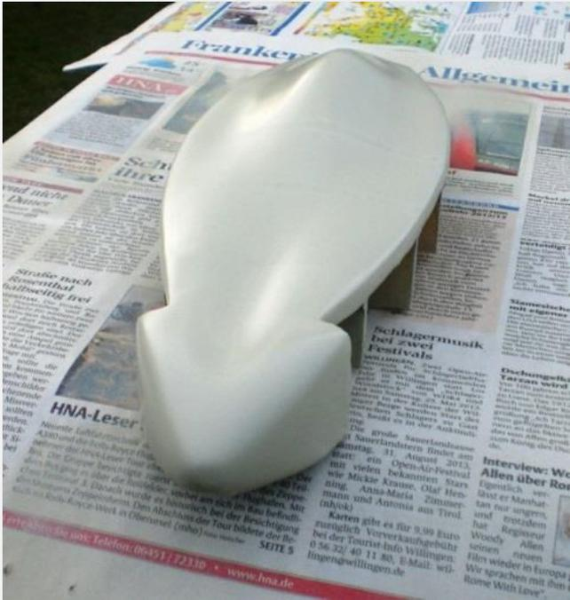
Hat man eine durchgehende, glatte Lack- oder Füllerschicht (wenn man nur Filler verwendet, muss zunächst die Verträglichkeit von Filler und Grundierwachs getestet werden) erreicht, wird die Oberfläche schrittweise bis zum 800er (oder mehr) Schleifpapier nass geschliffen. Anschließend mit einer Feinpolitur poliert.
