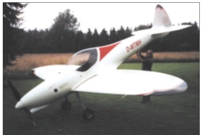
Flugzeugrumpf in Waben-Sandwichbauweise (Projekt Silence)
