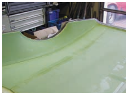
37 Der verpresste Sandwichkern. Hier wurde bereits der komplette Vakuumaufbau entfernt und der Formrand gesäubert.
