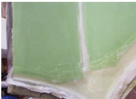
43 Sandwich - der nicht verstärkte Bereich wird mit drei Lagen Glasgewebe 163g/m 2 auflaminieren.
