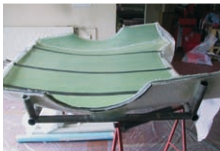
47 Das fertige Bauteil in der Form. Nach erfolgter Temperung (15 h bei 55 °C) wird entformt und evtl. überstehende Ränder besäumt.
