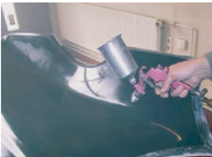
25 Spritzen des Folientrennmittels PVA.
