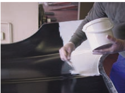
27 Auftragen des PU-Gelcoats mit einem Modlerpinsel.
