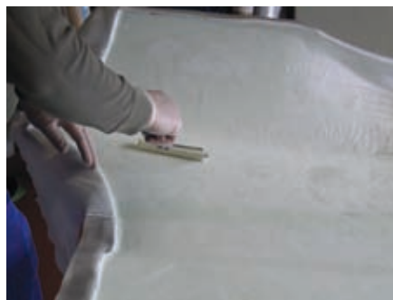
30 Die Gewebelagen werden sorgfältig mit einer Velourwalze getränkt.
