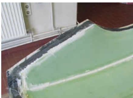
41 Verrunden der Ecken und Kanten mit eingedicktem Epoxydharz.
