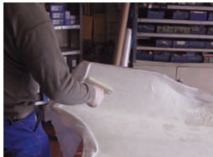
29 Laminieren der Deckschicht: 1 x Glasgewebe 80 g/m 2 , 1 x Glasgewebe 163 g/m 2 mit Epoxydharz L und Härter EPH 161.
