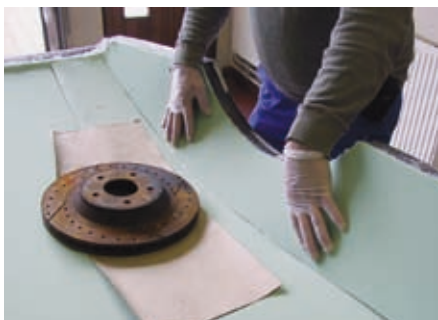
32 Zuschneiden des Airexkerns mit 5 mm Stärke. Teilstücke werden mit Gewichten beschwert, um ein Verschieben zu verhindern.
