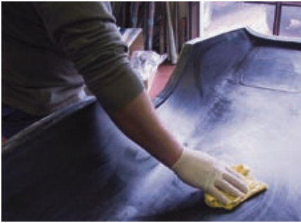
24 Auftragen von Grundierwachs in die Form. Form wurde vom Urmodell getrennt und wird jetzt vorbereitet für die Herstellung einer neuen, leichteren Motorhaube.
