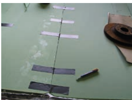
33 Fixieren der einzelnen Plattensegmente mit Klebeband.
