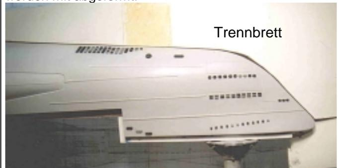
Ist das Urmuster gewachsen und zur Hälfte im Trennbrett versenkt, werden alle Trennfugen mit Modelliermasse sauber verschlossen und dann Trennmittel aufgetragen. Für jede spätere Durchführung durch das Laminat wird ein passendes Füllstück auf das Ur-Muster geklebt. Füllstücke werden aus Silikon in der jeweils benötigten Größe hergestellt.
