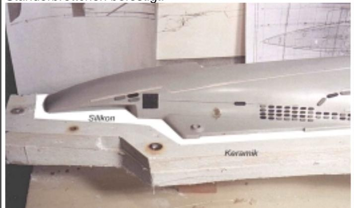
Ist die Form gut durchgetrocknet wird der Rahmen entfernt die erste Formhälfte umgedreht und vom Trennbrett befreit. Zur Sauberhaltung des Keramikrandes und zur Abdeckung der Schraubhülsen werden diese mit Kreppband abgeklebt und anschließend alles noch mal mit Trennmittel eingesprüht.
