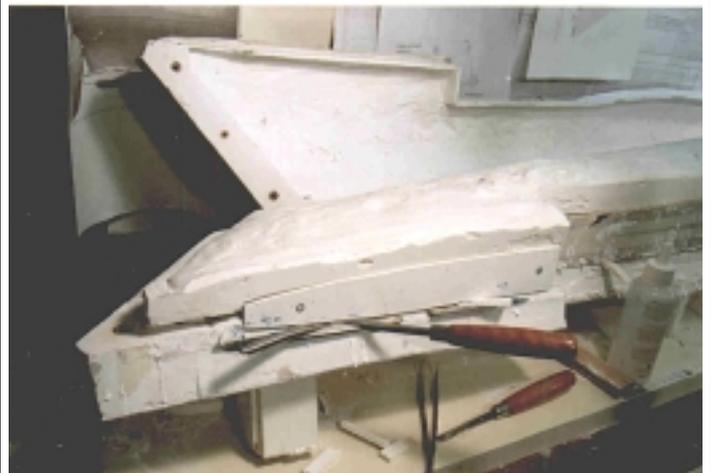
Zuerst wird die obere Keramikform abgehoben, die Siliconform auf das Urmuster belassen, dann die untere Siliconform mit Urmuster aus die untere Keramikschale gehoben.
