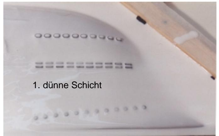
Über die Siliconform wird Keramikmasse mit M1 Gewebe als Verstärkung aufgebracht.
