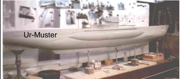
Hier rauf werden sämtliche Details, Schweißnähte, Nieten, und spätere Durchbrüche eingeplant und angebracht. Alle freidurchflutende Flutschlitze, davon gibt es jede Menge, werden mit abgeformt.
