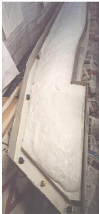
Zuerst wird die dünne dann die angedickte Siliconschicht aufgetragen. Der Rahmen wird nach Erhärtung entfernt und die Gewinde und Passstiftgehäuse aufgesetzt. Für die Keramikmasse wird wieder ein Rahmen gesetzt. Ist die Keramikmasse aufgebracht und durchgetrocknet wird der Rahmen entfernt.
