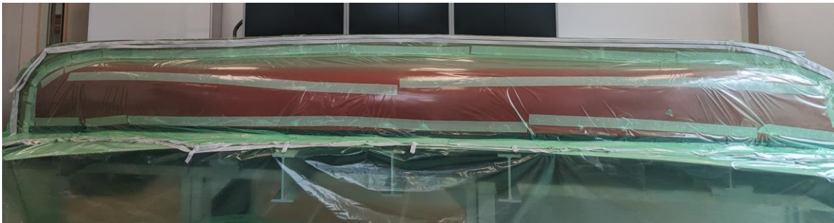
Abbildung 2 In Vakuumfolie eingepacktes Urmodell mit vorpräpariertem Vakuumdichtband
