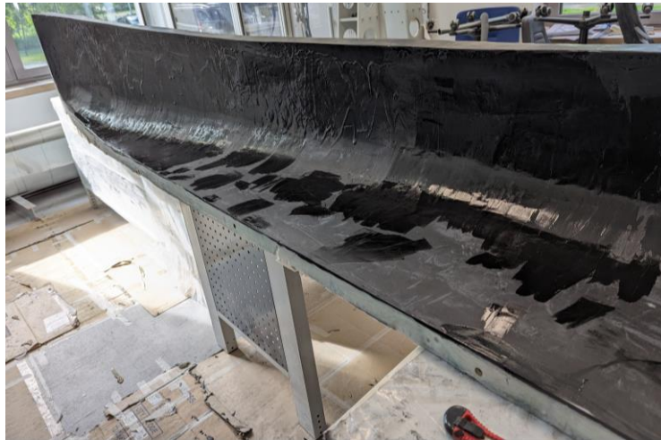
Abbildung 8 Mit Formbauharz beschichtete und abgeschliffene Form. Mit stellenweise aufgebracht zweiter Formbauharzschicht
