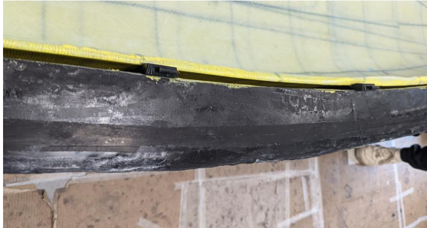
Abbildung 17 Entformungskeile zwischen Form und Bootswand
