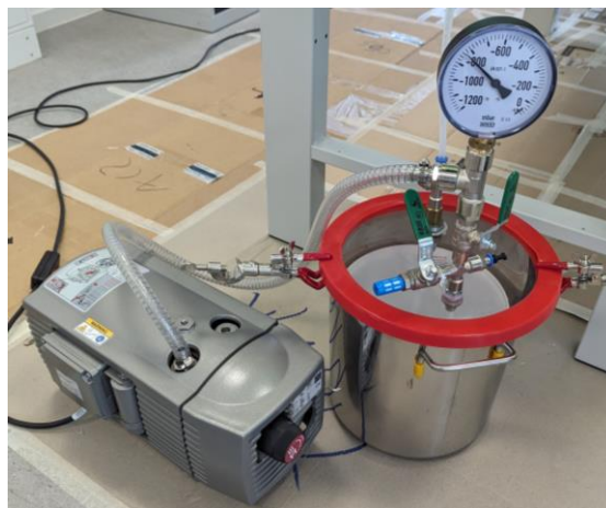
Abbildung 5 Drehschieber-Vakuumpumpe VT 4.10 mit vorgeschalteter Harzfalle, Manometer und Belüftungsventil
