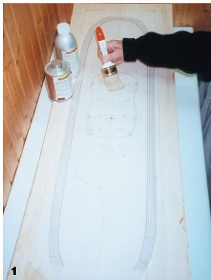
Bild 1: Auf die Form wird eine Unterlage (Folie, Transparentpapier) aufgelegt. Die Unterlage wird mit Trennwachs oder Folientrennmittel eingestrichen. Besonders sicher ist eine Schicht Folientrennmittel auf einer Schicht Grundierwachs. Als weitere Möglichkeit empfiehlt sich die -selbsttrennende- R&G Vakuumfolie, bei der auf Trennmittel verzichtet werden kann.
