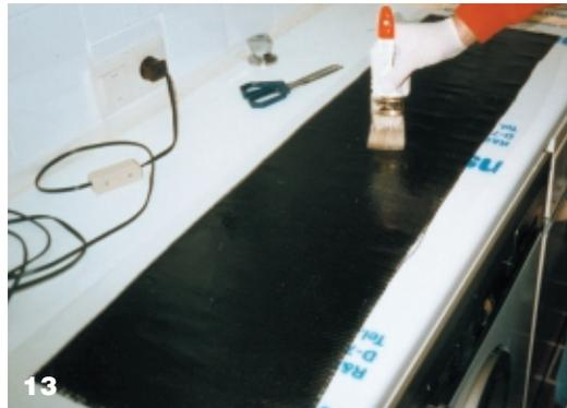
Bild 13: Die dritte Gewebelage (204 g/m<sup>2</sup>) wird vorgetränkt und auf die beiden ausgehärteten Schichten aufgelegt. Durch das Stupfen mit einem Pinsel werden Lufteinschlüsse vermindert. Wichtig ist, daß auf dem Laminat keine Harzanhäufungen ("Harzseen") zu erkennen sind. Sie machen das Board unnötig schwer und tragen nicht zur Festigkeitssteigerung bei.
