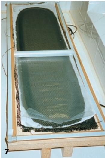
Bild 7: Für die Boardunterseite werden zunächst zwei Schichten Kohlefasergewebe (204 g/m<sup>2</sup>) in Längsrichtung laminiert. Das Laminat wird mit Abreißgewebe, darauffolgend mit einer Lochfolie bedeckt, ...
