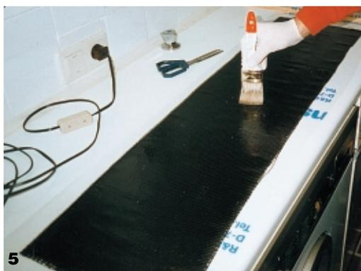
Bild 5: Das Kohlegewebe wird auf einer Folie mit Harz vorgetränkt. Durch das Stupfen mit dem Pinsel wird die Wahrscheinlichkeit von Lufteinschlüssen vermindert. Statt einem Pinsel kann auch eine Rolle verwendet werden.
