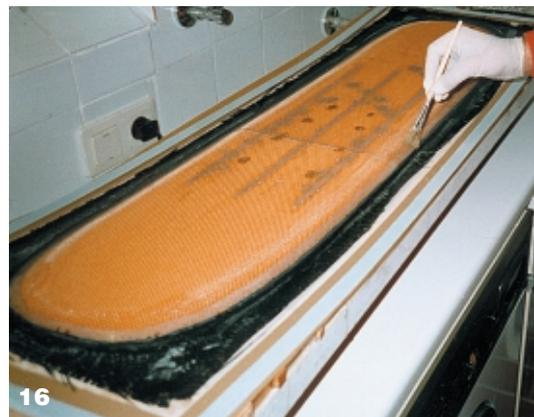
Bild 16: Der Randbereich wird mit dem gleichen Gemisch verstärkt. Die niedrigere Wabenzellhöhe erlaubt hier die Verwendung eines Pinsels.
