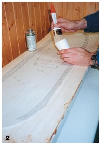
Bild 2: Auf die imprägnierte Unterlage wird eine Schicht UP-Vorgelat aufgetragen. Nach ca. 8 Stunden erfolgt ein zweiter Anstrich. Die ca. 0,2 mm dicke Schicht schützt das Board vor UV-Strahlung und das Laminat vor Kratzern. Mit dem Lösemittel Styrol (Bild) kann die Viskosität des UP-Harzes bis hin zur Spritzfähigkeit eingestellt werden.
