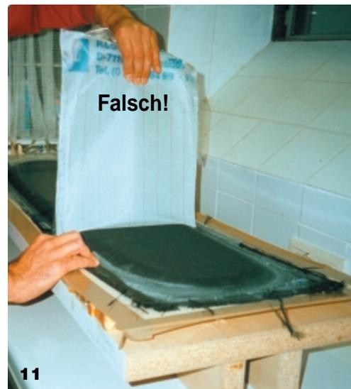
Bild 11: So sollte das Abreißgewebe nicht entfernt werden! Der Kraftaufwand ist höher und es besteht Beschädigungsgefahr des Laminats (das Laminat kann aus der Form herausgehoben werden).
