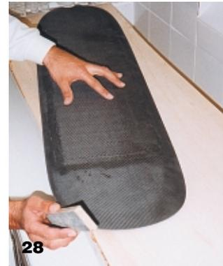
Bild 28: Der Rand wird geschliffen. Zuerst mit rauhem Schleifpapier (Korn 60 - 80), anschließend mit Körnungen bis 600. Als abschließender Arbeitsgang wird das Board auf der Oberseite mit zwei Schichten R&G UP-Vorgelat (Polyester-Deckschichtharz) versiegelt.
