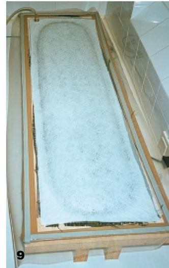
Bild 9: Die ersten zwei Schichten des Boards werden im Vakuum ca. 24 Stunden bei ca. 20 °C verpresst.
