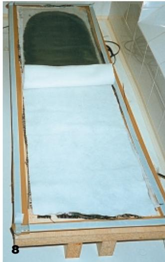
Bild 8: ...mit Saugvlies belegt und dem Folienschlauch und Vakuumdichtband luftdicht versiegelt.
