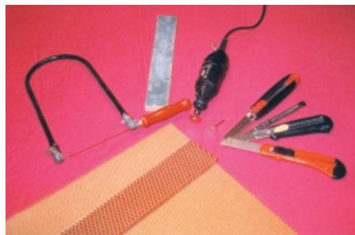
Abbildung 1: Bearbeitungswerkzeuge für Aramidwaben: Laubsäge mit feinen Metallsägeblättern, Schleifpapierfeile, Schleifpapier mit verschiedenen Körnungen, elektrische Werkzeuge mit Fräs- und Schneidwerkzeugen, diverse Arten von scharfen Messern.
