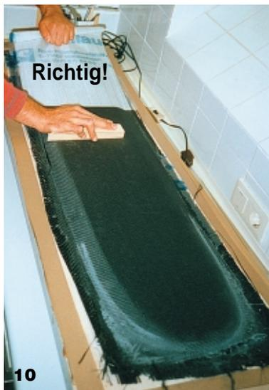
Bild 10: Das Abreißgewebe wird vom ausgehärteten Laminat in einem möglichst flachen Winkel abgezogen (abgerissen). Die Laminatoberfläche weist eine rauhe, fettfreie Struktur auf. Auf diese Oberfläche kann ohne weitere Vorbehandlung weiterlaminiert werden. Zur Vermeidung von Körperfetten auf der Laminatoberfläche dient ein Holzklötz zur Abstützung.
