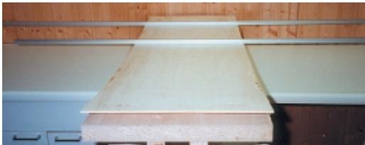
Abbildung 2: Geradheitskontrolle mittels zweier Leisten
