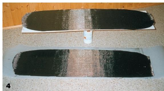
Bild 4: ...auf eine stabile Unterlage (Hartfaserplatte, dickes Papier) bis zur Verarbeitung gelagert. Dadurch wird ein Verschieben einzelner Fasern durch unsachgemäße Handhabung vermieden.
