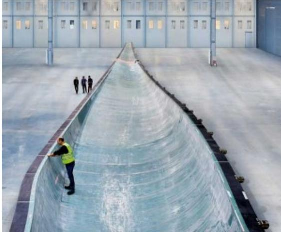
Abb. 5-17: Fertigung eines Rotorblattes von einer WKA
