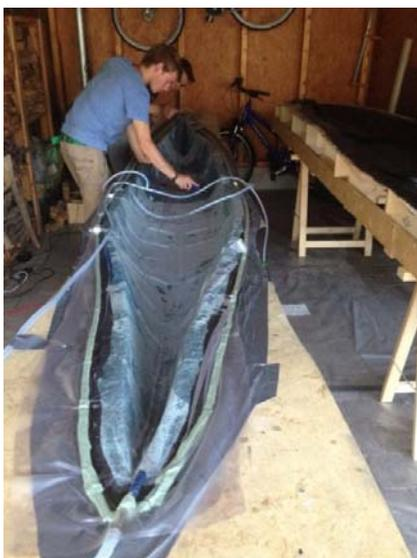
Abb. 7-36: Abdichten des Vakuums
