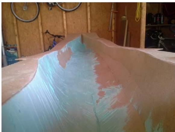
Abb. 7-13: Auftragen der Spachtelmasse
