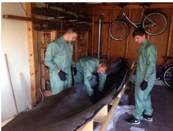
Abb. 7-28: Einlegen der Deckschicht
