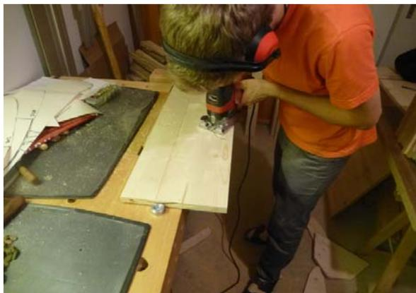
Abb. 7-4: Aussägen der Querschnitte
