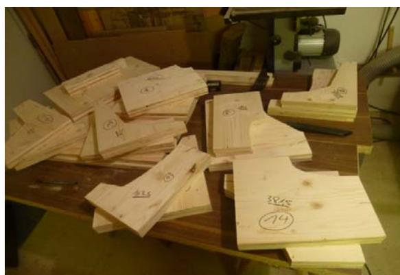
Abb. 7-5: Die Hälftenpaare der Spanten
