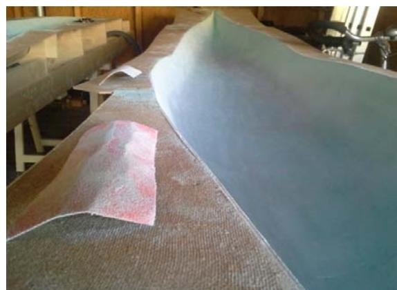
Abb. 7-19: Fertig geschliffene Unterhälfte
