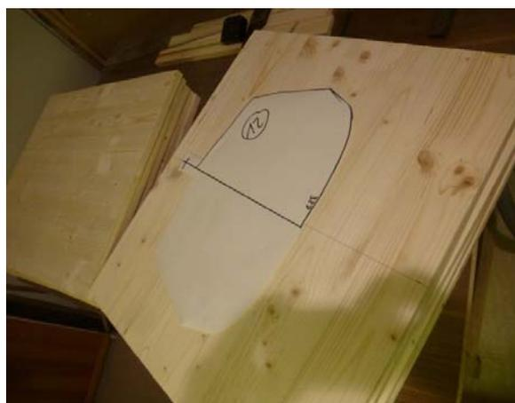
Abb. 7-3: Übertragen der Querschnitte
