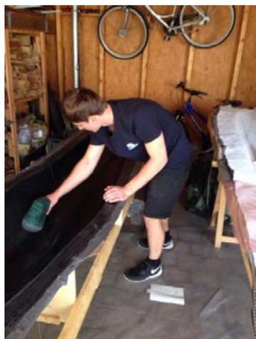
**Abb. 7-24: Gelcoat schleifen**
