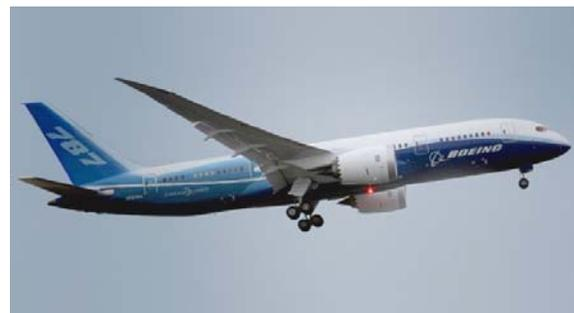
Abb. 5-14: Boeing 787 Dreamliner. Der komplette Rumpf und die Flügel bestehen aus FVW
