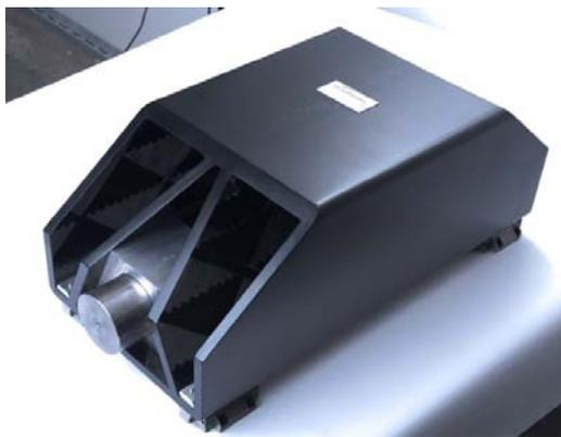
Abb. 5-18: Anlagenteil aus CFK
