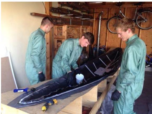
Abb. 7-30: Positionierung der Schaumkerne
