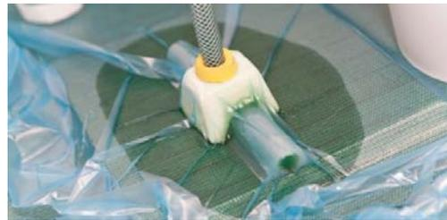
Abb. 5-11: Vakuuminfusion
