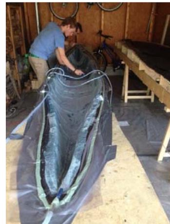
Abb. 5-9: Handlegeverfahren mit Vakuum
