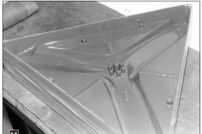
11) Wie zu Anfang wird eine neue Umrandung mittels Blechschrauben an der unteren Formhälfte angebracht.
