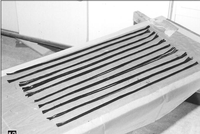
13) Eine mit Folie bespannte Spanplatte dient zum Tränken der Kohlerovings.
