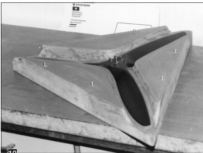
10) Die gereinigte Form wird mehrmals mit Grundierwachs behandelt. Paßstifte und Paßbuchsen wie vor beschrieben aufstecken. Auf dieser Formhälfte werden mit Wachsstreifen oder Modelliermasse 8-10 mm breite und ca. 2 mm dicke Streifen zwischen den Blättern angeformt; sie verlaufen vom Formrand hin zur Nabe und dienen als Überlaufkanal für überschüssiges Harz und als Öffnung zum Aufknebeln der Form. Wie das genau aussieht, ist auf den Bildern 11, 16 und 17 ersichtlich.
