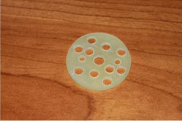
Epoxi-Ruderhörner, Gestängeanschluss mit 1,1 mm Loch
