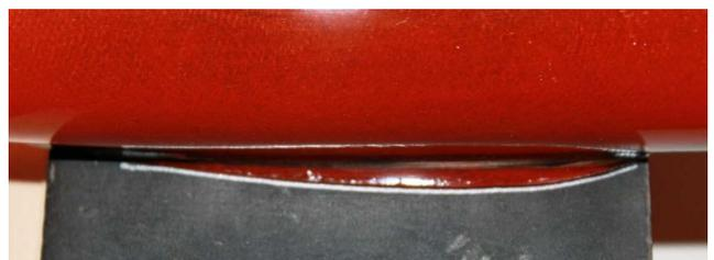
Schieben sie probeweise das Höhenleitwerk unter die Seitenflosse. Sie werden sehen, bei der von Ihnen eingestellten Rumpfunterlage, passt sich das Höhenleitwerk durch die Gewichtsverlagerung von selbst an die Seitenflosse des Rumpfes an. Merken Sie sich die so gefundene Lage, indem Sie diese anzeichnen. Oder wie auf den Bild unten durch die Kante des Baubrettes und zwei Anschläge. Den so gefundenen Punkt können dann leicht wiederfinden.
