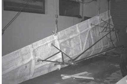
Die Formrückseite wird zur Versteifung mit Rippen aus
