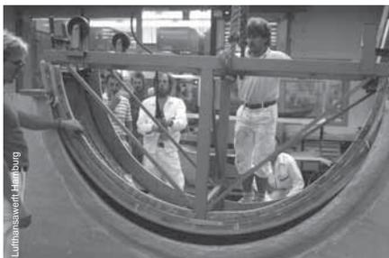
Triebwerksverkleidung für eine General Electric CF
