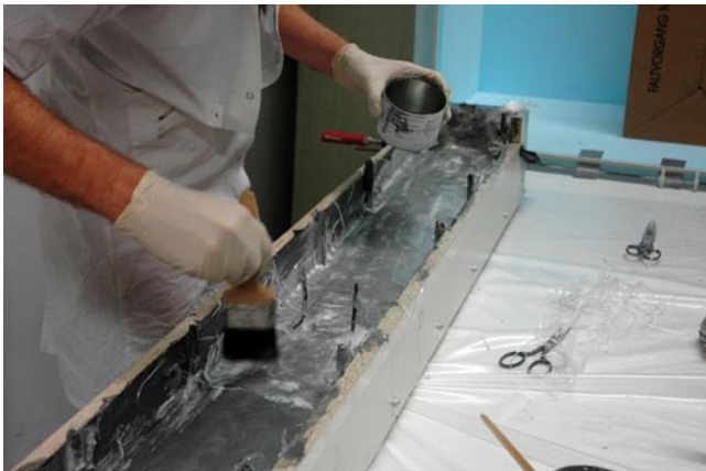
Einlaminieren der Glasgewebe (Abbildung 1-4)
