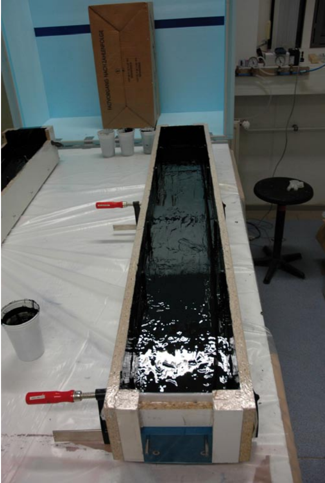
Komplette Form mit Formenharz beschichtet
