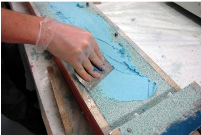
Auftragen des Harz-/Glass Bubble-Gemisches
