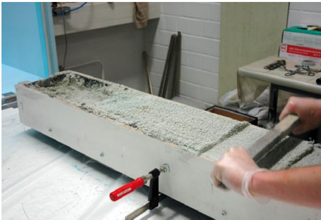
Auffüllen des Formhohlraumes
