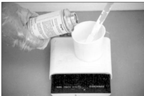
Für Beschichtungen wird das UP-Vorgelat mit 10 % Styrol verdünnt.
